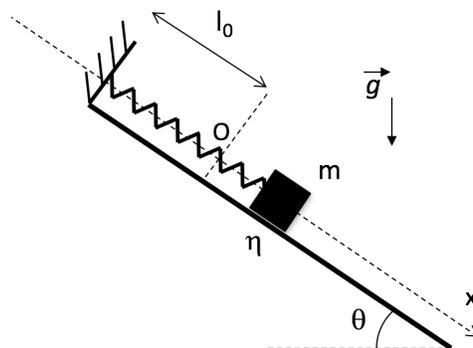
FIG. 4 – Suspension par un ressort, avec frottement.
