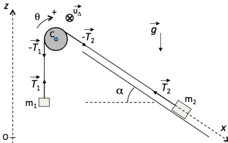
FIG. 6 – Schéma du dispositif comprenant une poulie, deux solides et un plan incliné.
